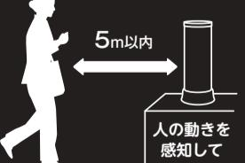
スイッチをAUTOにしておくと、明るい時は点灯せず、暗くなると人の動きに反応して点灯します。また、約20秒点灯した後、自動的に消灯するので、電池の省エネになります。
